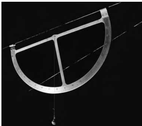
Grádový závěsný sklonoměr a grádový závěsný kompas z hornické závěsné soupravy firmy »Freiberger Präzisionsmechanik« made in GDR (foto: Martin Příbil)
