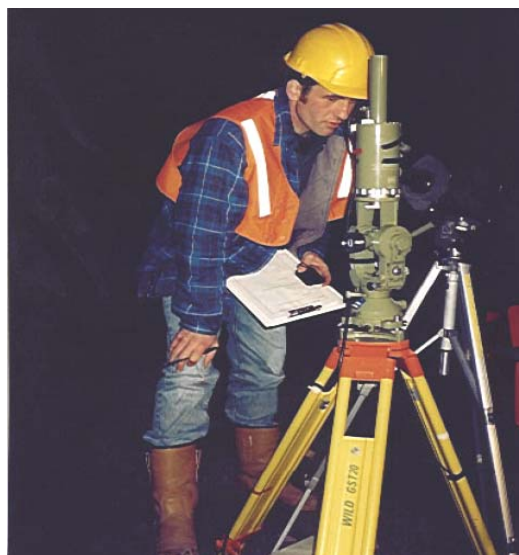
Obr. 2. Teodolit s přidaným gyroskopem
