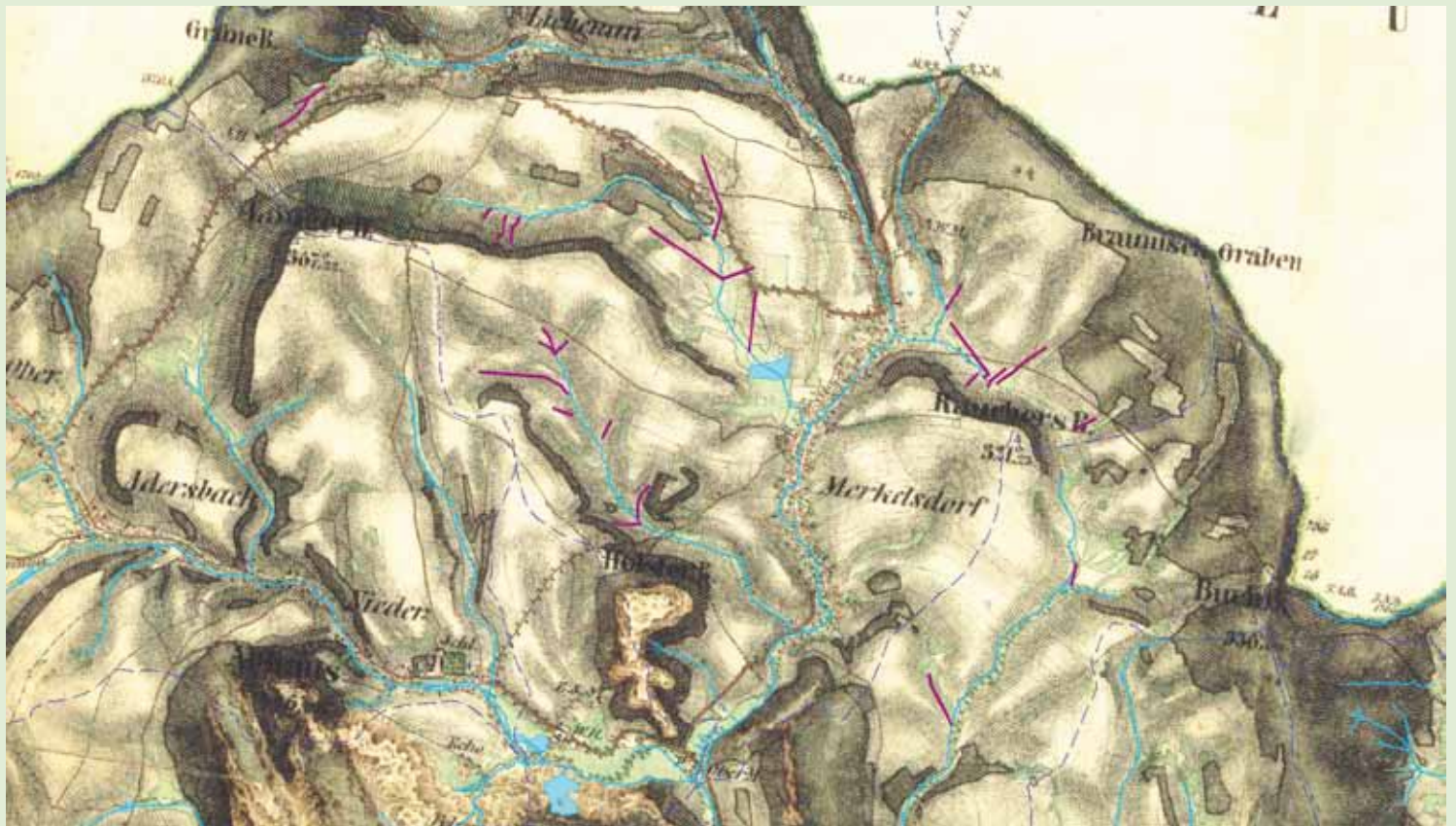
Obrázek 19: Meliorační hlavničky (fialová čára) o celkové délce 5,2 km na Zdoňovsku „vytažené“ z grafiky Studie na podkladu mapy III. vojenského mapování z první poloviny 19. století. Na první pohled je zřejmé, že skoro všude, kde je dnes louka či pole a v něm položené trouby pod zemí, šlo v době mapování o toky a mokřadní louky. Krajina proto dávala dostatek vody a toky tekly celý rok. Dále je vidět, že délka toků se zkrátila právě o délku položených trub. Ve skutečnosti však byla ale většina přítoků narovnána zrušením meandrů, takže délka toků Zdoňovska se snížila minimálně o 7,6 km. Autor: Jiří Malík a Lukáš Panny.
