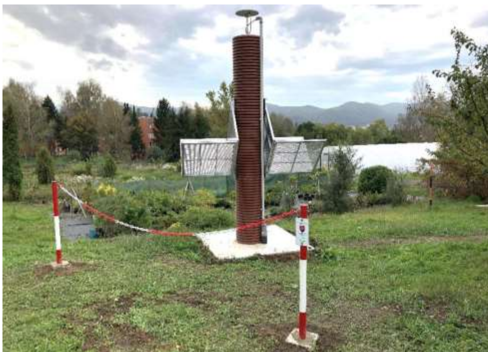
Obr. 94 SKPOS stanica Zvolen – Borová hora s kútovým odrážačom pre metódu InSAR
