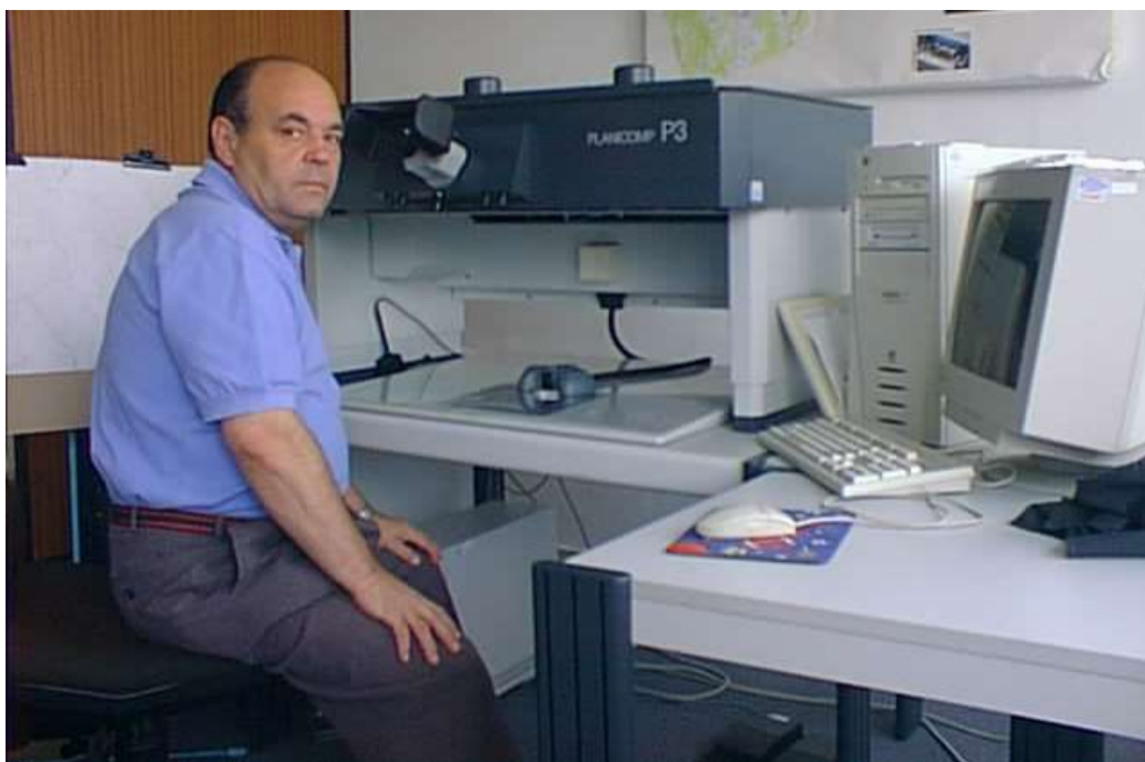
Obr. 39 Vyhodnocovací prístroj Zeiss Planicomp P3 používaný na GKÚ [86]
