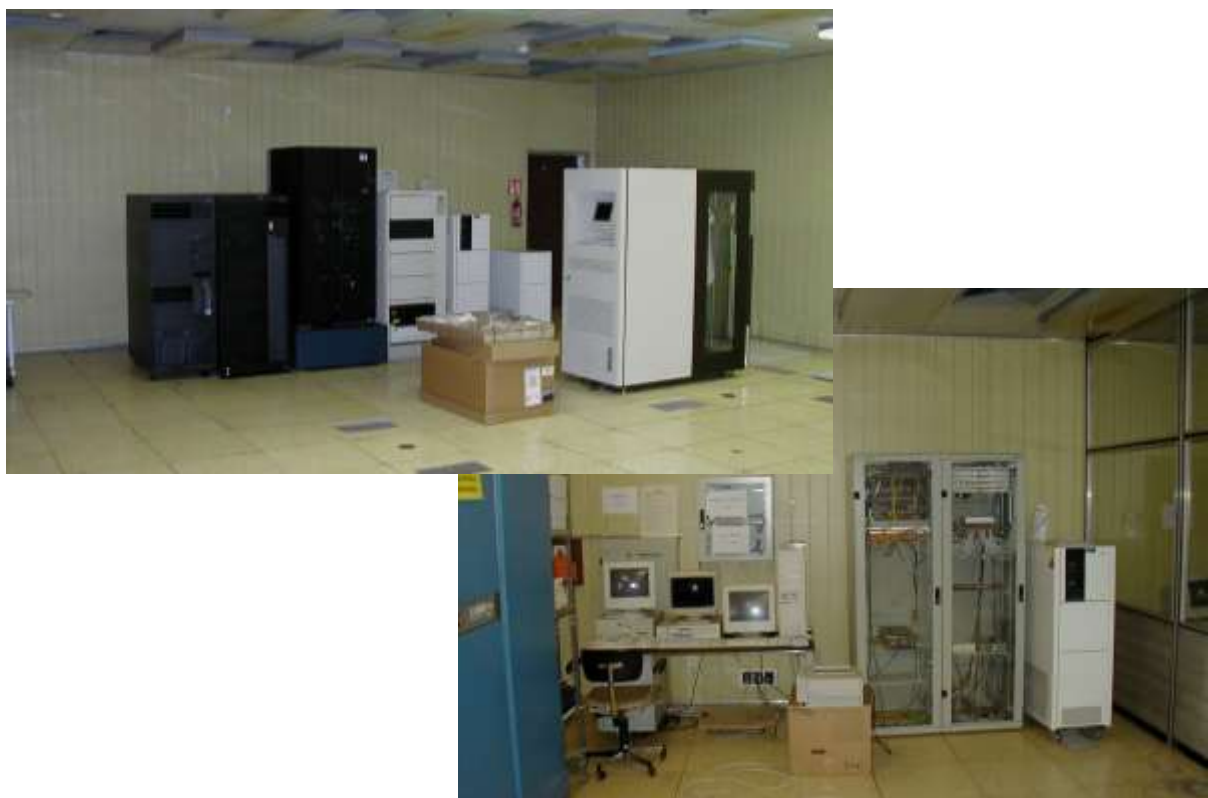
Obr. 37 Sálková počítač IBM RS/6000 SP(hore) a rack s aktívnymi prvkami siete (dole) [99]
