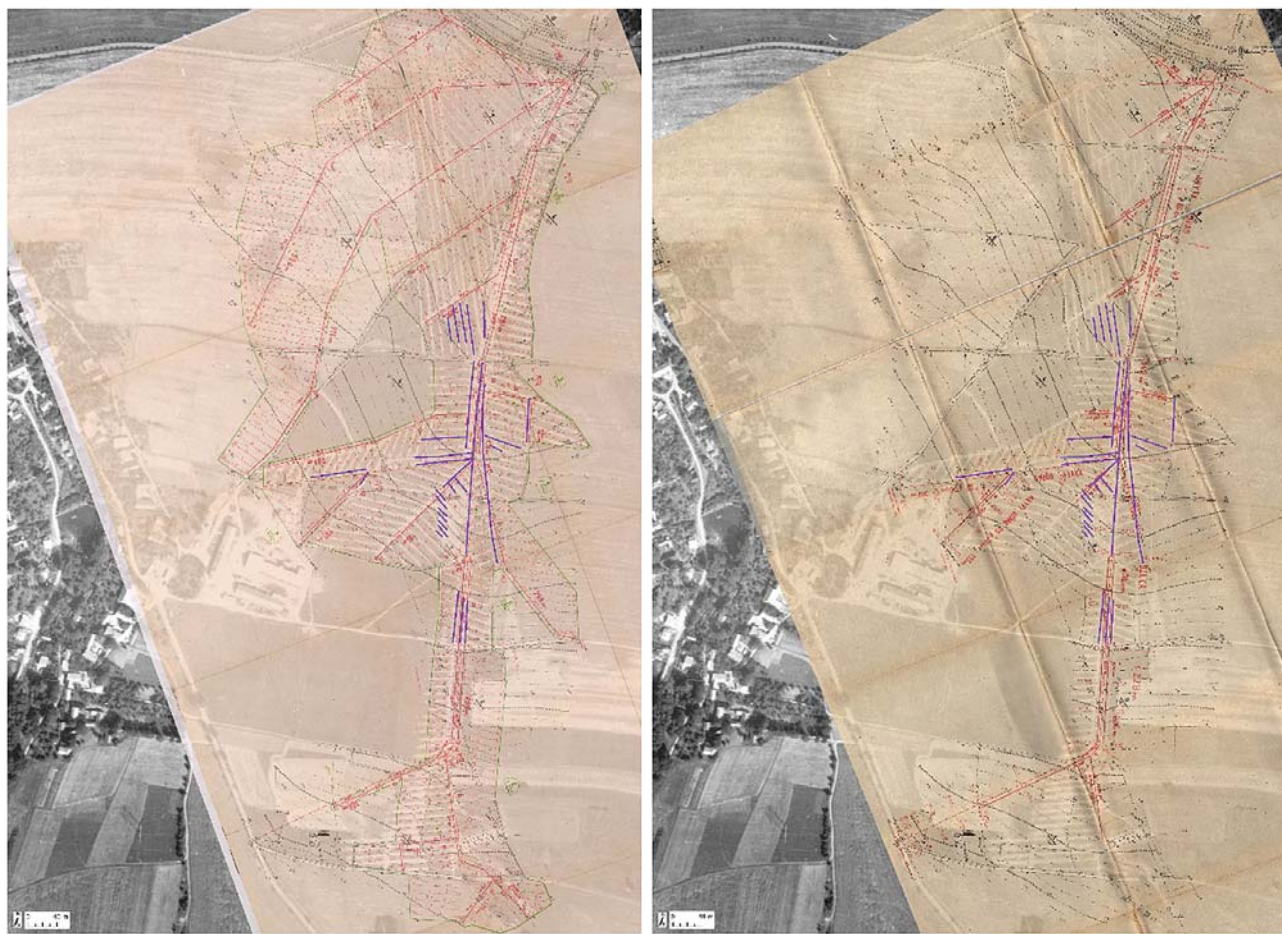
Obr. 7 Overlay původního projektu POŽ (viz obr. 4) a ALMS s vyznačenými liniemi viditelných drenů na aktuálním snímku (levá část obrázku) a overlay původního projektu vybraných odpadů a ALMS s vyznačenými liniemi viditelných drenů na aktuálním snímku (pravá část obrázku)
