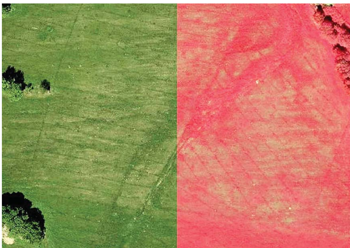
Obr. 9 Prvky drenážního systému na RGB ortofoto (levá část obrázku) a na ortofoto v nepravých barvách – CIR (pravá část obrázku)
